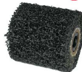
Con foro d'attacco Ø mm 19,1 e sede per chiavetta. Adatte per le più diffuse smerigliatrici, lucidatrici e satinatrici. In gomma abrasiva per satinare acciai inossidabili. Dimensioni mm 100x100. Velocità massima 1910 giri/min.
