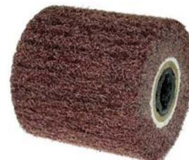
Con foro d'attacco Ø mm 19,1 e sede per chiavetta. Adatte per le più diffuse smerigliatrici, lucidatrici e satinatrici. In tessuto-non tessuto ad alta impregnazione. Abrasivo al carburo di silicio, per ottenere puliture di ruggini, sbavature di saldature, sverniciature di metalli, legni, intonaci, cemento. Non danneggia e non surriscalda la superficie da lavorare. Dimensioni mm 100x100. Velocità massima 6800 giri/min.
