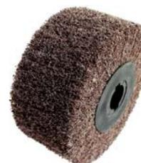
Con foro d'attacco Ø mm 19,1 e sede per chiavetta. Adatte per le più diffuse smerigliatrici, lucidatrici e satinatrici. Con tessuto abrasivo in materiale fibroso sintetico per rimuovere ossidazioni e satinare leghe al Cromo Nickel, leghe leggere, metalli dolci, legni ecc. Dimensioni mm 100x100. Velocità massima 5700 giri/min.
